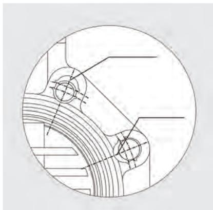
Inserire le lunette nei fori secondo la posizione indicata nella tabella, dal lato corrispondente alla scritta con D e DN per facilitare l'inserimento dei tiranti e l'accoppiamento con le flange (DN 40 ÷ 200). Le lunette di autocentraggio devono essere inserite nelle apposite guide delle asole sul corpo valvola lato scritte con le scritte verso l'alto, e posizionate secondo la tipologia di foratura delle flange come indicato nella tabella seguente:
